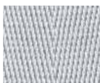
Trame de type chevrons K Rainure d'air positionnées en chevrons
