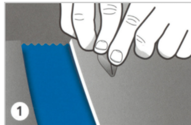
1 Imprägnierung der Laufseite entfernen und Stift/ PIN einfetten.
